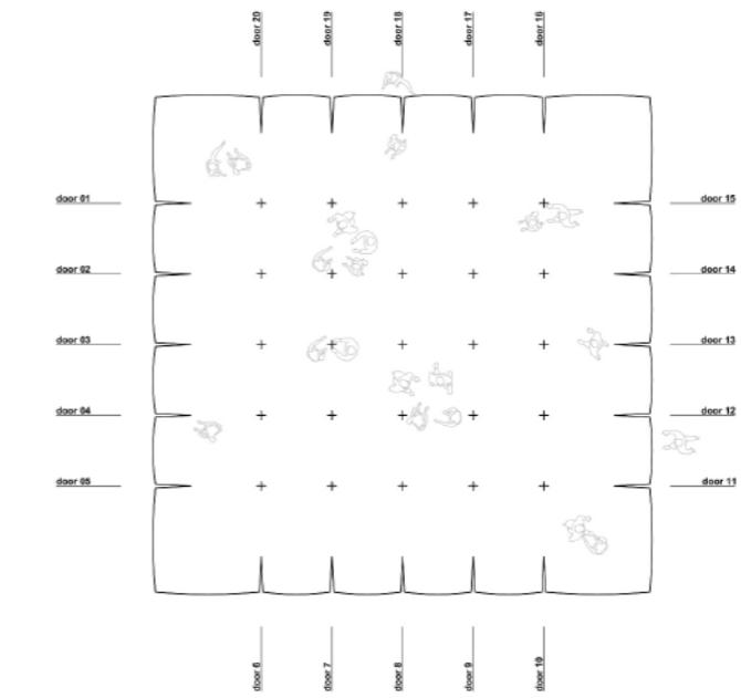
The Bubble explora el concepto de permeabilidad en el campo de las estructuras neumáticas. La planta cuadrada huye de la geometría típica de un hinchable para generar una pastilla poligonal con cuatro frentes en los que se encuentran ocultos los 20 accesos. El interior es un bosque de tensores de diferentes tonalidades que dividen el espacio en una cuadrícula de celdas habitables.
